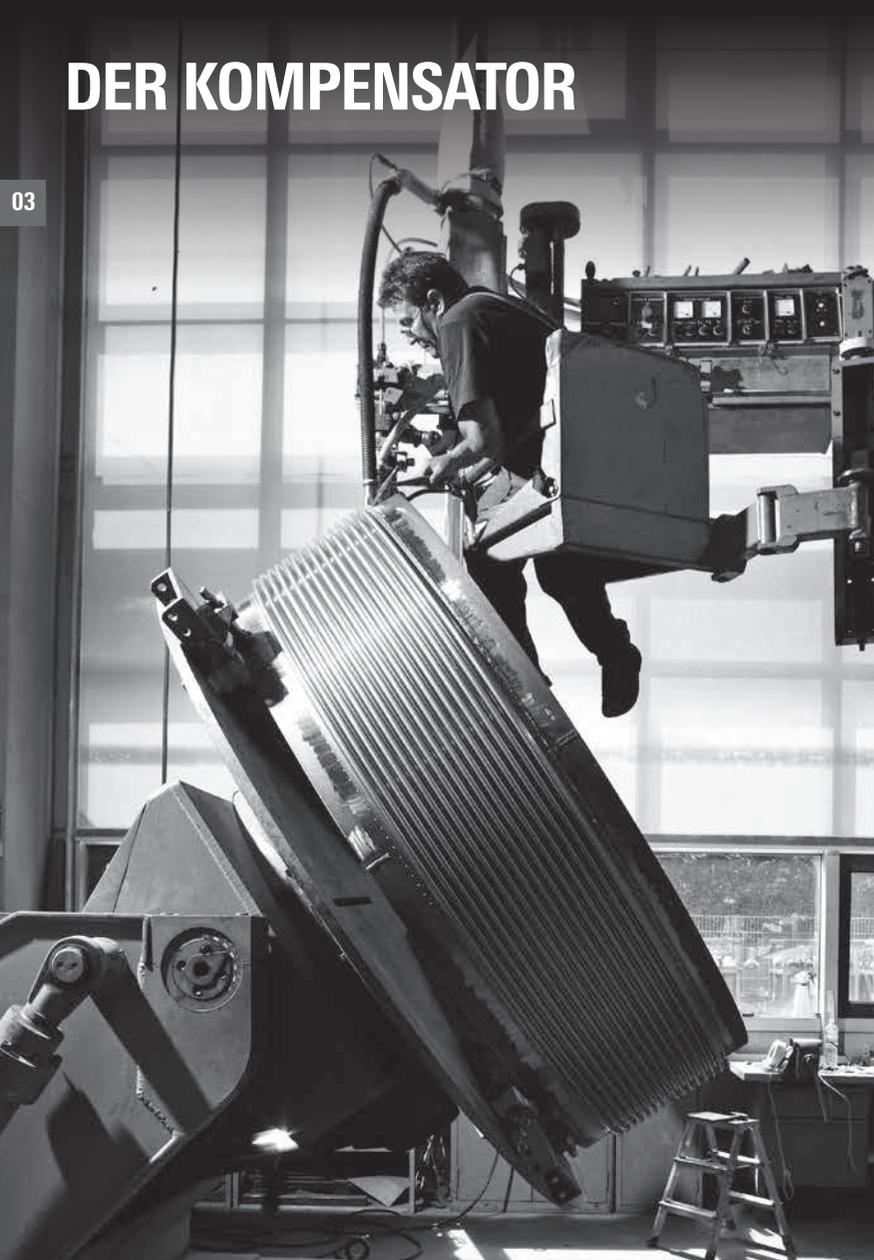
Kompensatoren in ihren verschiedenen Bauformen (Beispiele siehe Bild 3.1 und 3.2) dienen dem Bewegungsausgleich in Rohrleitungen, an Maschinen und Apparaten. Die Bewegungen, immer Relativbewegungen zwischen zwei Anlagenteilen, werden durch Wärmedehnungen, Druckverformungen, Massenkräfte, Montageversatz oder Fundamentsenkungen hervorgerufen.
