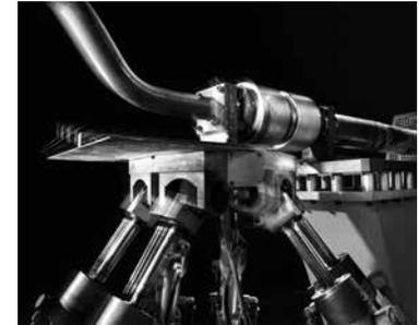
*Bild 2.5 Schwingungsprüfungs-Stand zur Simulation komplexer Anwendungsbedingungen.*
