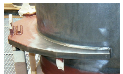
Umlaufend verschweisste Hammeranker zur Verhinderung von Spaltkorrosion
