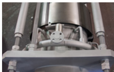
Ringleitung von oben mit Stützen für die Dampfeinblasung als Sperrströmung
