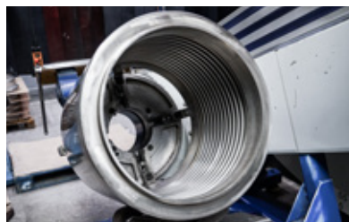
Vorbereitung zum Anschweißen der äußeren Schutzhülle
