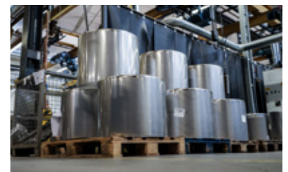
Nach allen Prüfungen, fertigungsbegleitenden Überwachungen und Kontrollen werden die Bauelemente mit 100 % chemisch reinem Wasser gereinigt bevor sie in halogenidfreie Folie eingeschweißt werden
